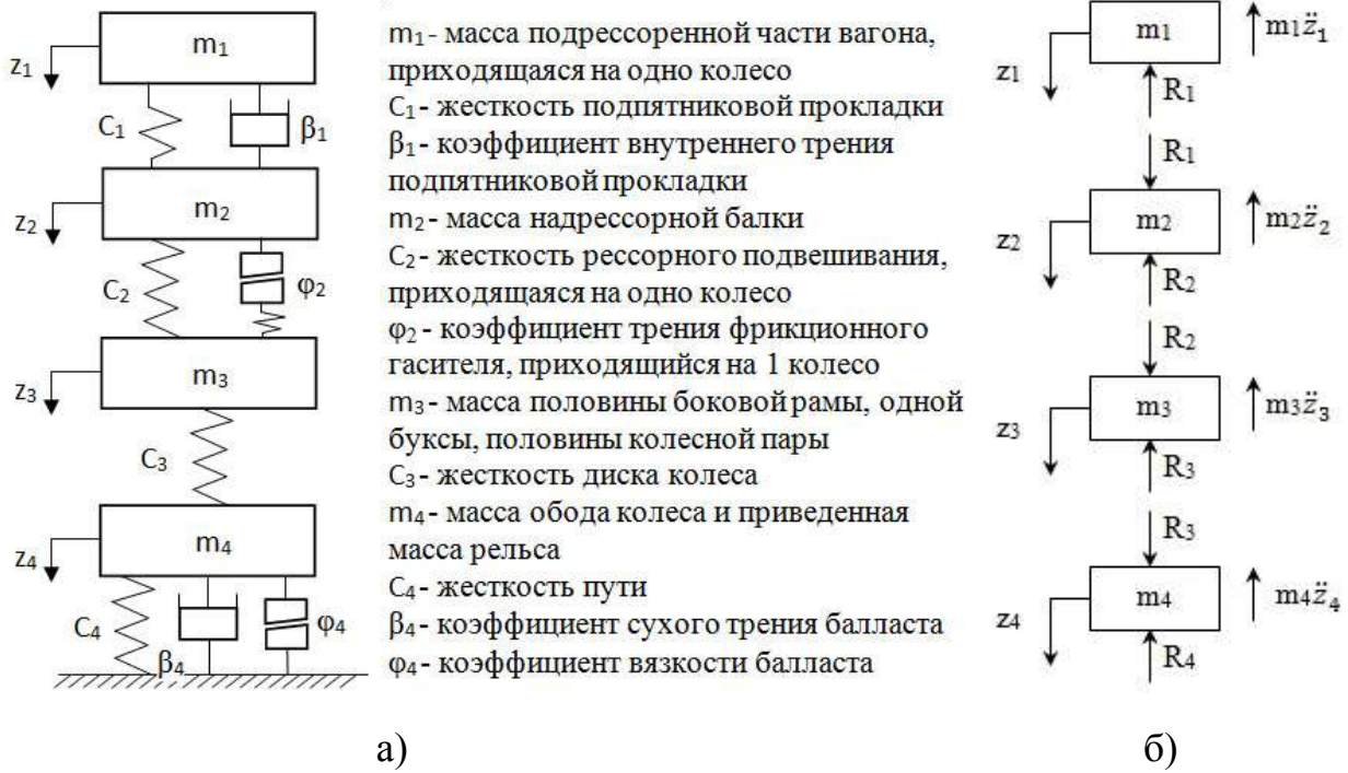
Рисунок 5 – Обобщенная модель (а) и расчетная схема (б) многомассовой колебательной системы «вагон-путь»
